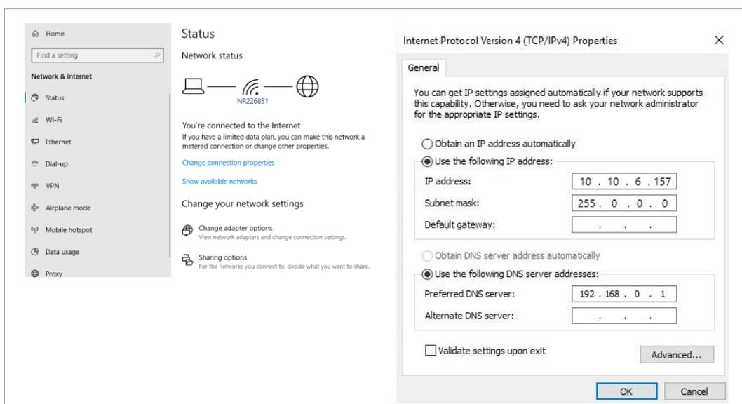
Fig. 1: IPv4 Parameter.
